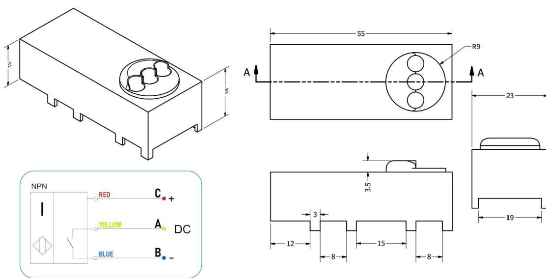
Використовуючи оптичну технологію, датчики насіння IR940 працюють за принципом фотодетекції. Інфра-червоні світлодіоди (LED) створюють тонке світлове поле по всій внутрішній частині насіннєвої трубки. Фотоприймач на протилежному боці трубки безперервно контролює інтенсивність світла, будь-яке насіння, яке порушує джерело світла, виявляється осередком фотодетектора, і відповідний імпульс передається на монітор. Постачається з 3 інфрачервоними світлодіодами для забезпечення точної швидкості сівби.
