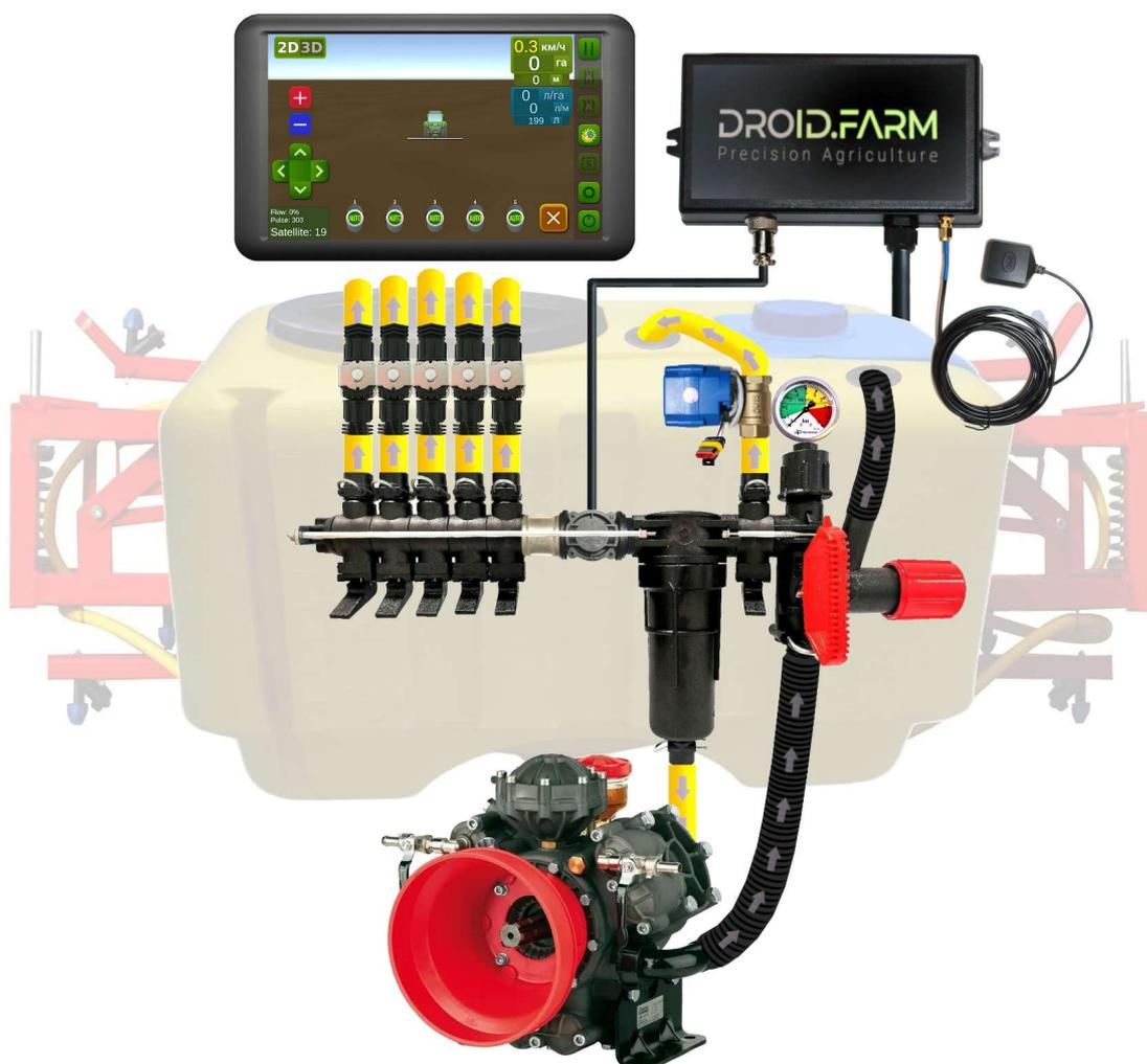
Используя SC10 для дозированного вылива средств защиты растений вместе с регуляторами в которых есть компенсаторы давления секций (на рисунке обозначены под номером №1), их нужно обязательно перекрыть, чтобы жидкость не шла обратно в бочку через выход №2. Регулятор просчитывает фактически вылитую жидкость через секции, после отключения секций автоматически регулирует давление в системе без необходимости применять компенсаторы давления.
